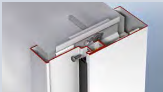
Через канавку для уплотнения привинтить профиль 2 доборной коробки к профилю 1 и затем вставить поверх данного соединения уплотнение двери
